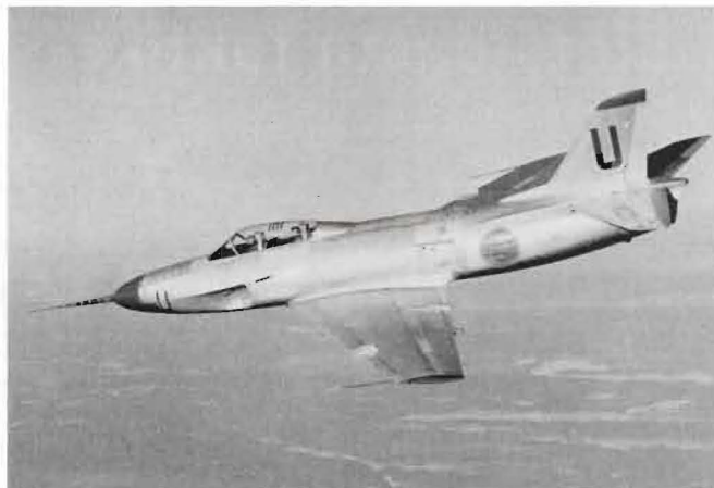
Prototypen för Saab A 32 Lansen var det första svenskbyggda flygplan som flög fortare än ljudet. Sprötet i nosen är ett pitotrör för tryckmätning i ostörd luft. Men den alltid lika välinformerade dagspressen visste berätta att sprötet användes för att "sticka hål" på ljudvallen. Foto: Saab
